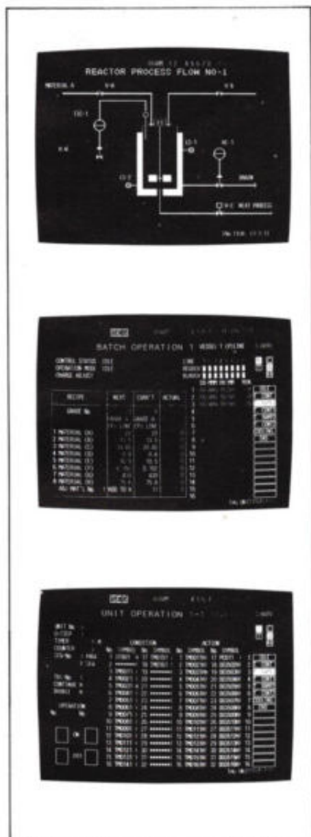
Afb. 8. De lokale bedieningseenheid TOS-DIC243 is ook te gebruiken voor het besturen van batchprocessen. Via het 'Batch Graphics', 'Batch Operation'- en 'Batch Unit Operation'-display (van boven naar beneden) heeft de operator een goed overzicht over het proces, de samenstelling van het gewenste product, de procescondities en de voortgang van het proces (foto's: Toshiba).
